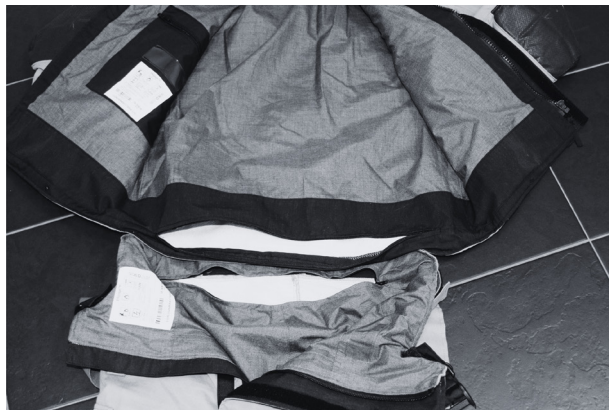
FIG. 2: Inspectiesysteem voor de voering van jas en broek (bevindt zich aan de onderkant van de jas en langs de tailleband van de broek)
