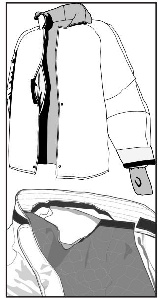
FIGURE 2A: Système d'inspection de la doublure de veste (le long de la face avant ou au niveau du col)
