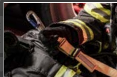
ENGANCHAR: engancha en el punto de interfaz sin convertir el equipo ni enhebrar la correa.
